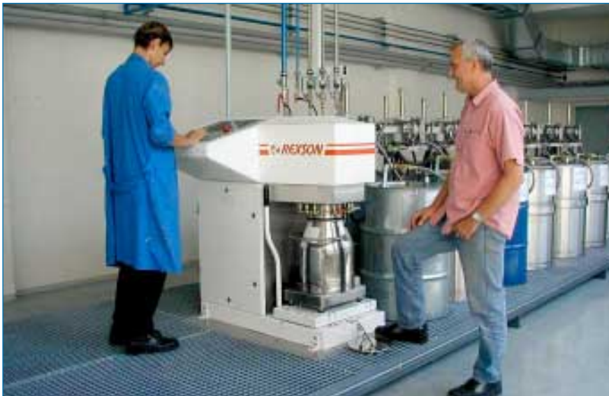
Automatická mísicí stanice potiskovacích barev ve Fatře.
